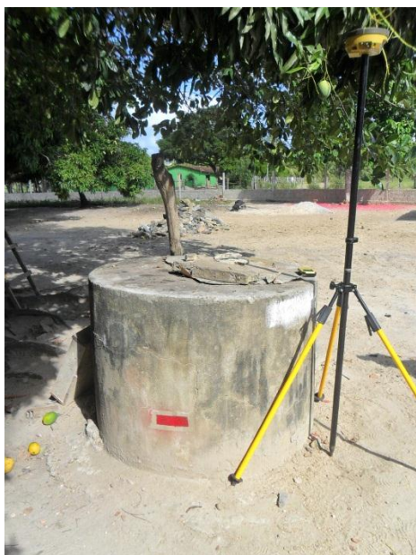
Foto 52. Nivelamento topográfico com GPS Geodésico em poço tubular
