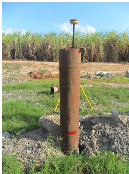
Foto 54. Marca de sinalização do entalhe do nivelamento topográfico
